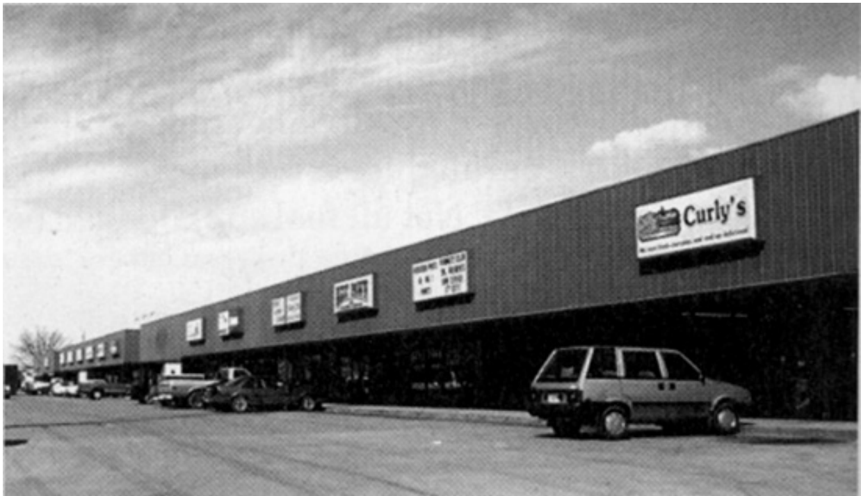
Gambar 2.7 Pusat perbelanjaan yang bentuknya memanjang seringkali memiliki perancah serambi loteng yang membantu penyebaran api ke seluruh bangunan.
